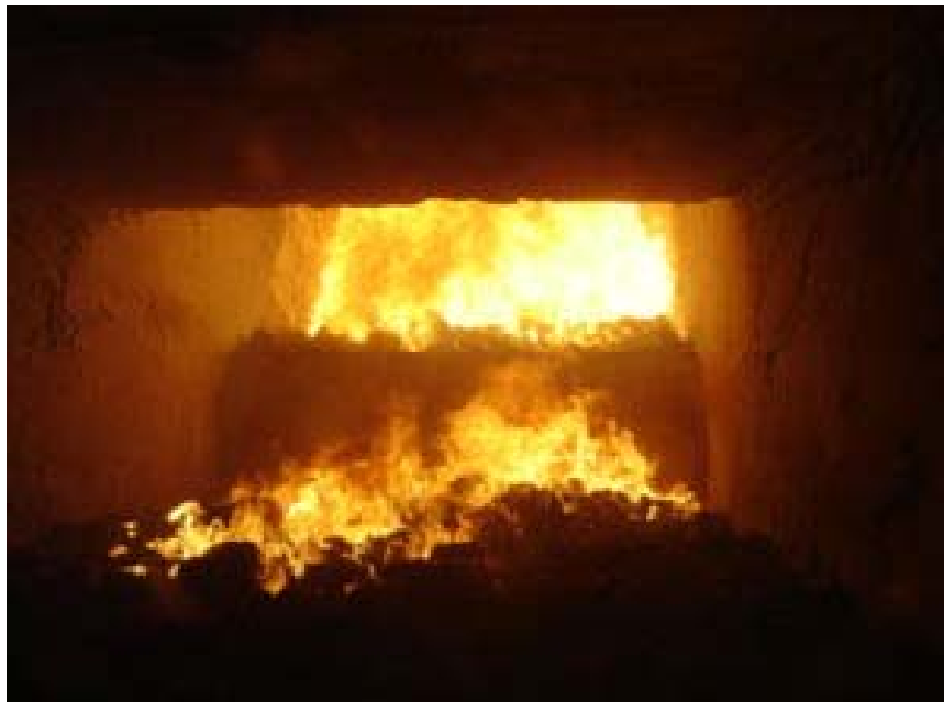
Figura 3.9: Interno del forno di un inceneritore a griglie
